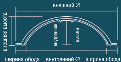
B2002 внутренний Ø 110,5 см внутренняя высота 17,0 см внешний Ø 129,5 см внешняя высота 19,0 см ширина обода 9,5 см
